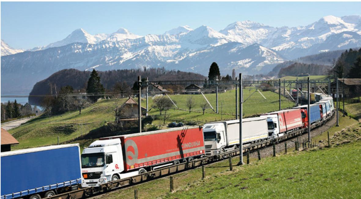
Abbildung 1: Sinnbild der Schweizer Verlagerungspolitik für den alpenquerenden Güterverkehr – nordwärts fahrender RoLa-Zug auf der Lötschberg-Simplon-Achse bei Spiez. Bildquelle: RAAlpin.
